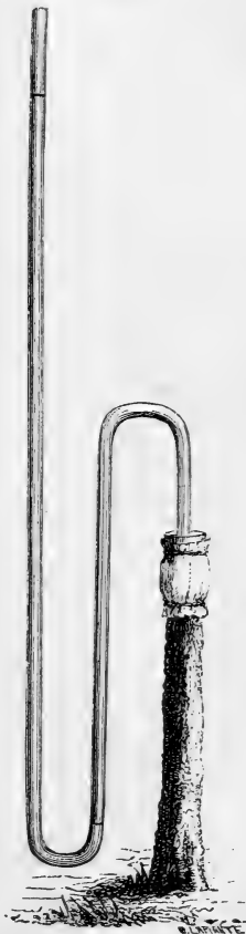
Stam van een wijnstok, met omgebogen glazen buis, voor het meten van de drukkracht der wortels.
